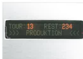
Großextanzzeige mit aktuellen Daten zum Betriebszustand der Anlage. Large-scale display showing data on operating status and bundle sequence.
