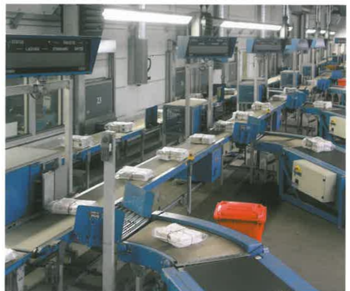
Abtransportsystem mit Tourenverwaltung und alphanumerischer Textanzeige bei WE-Druck GmbH & Co. KG, Oldenburg.
